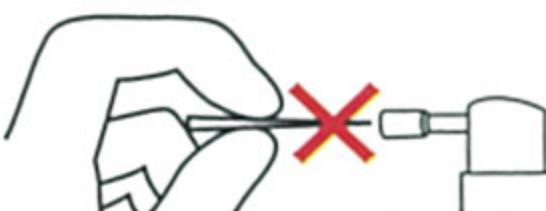
ノズルの先端を針等で突くと薬液が出にくくなったり、折れた時大変危険です。絶対におやめください。
